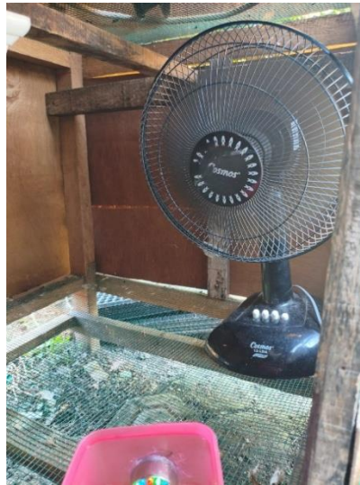
Gambar 11. Kondisi kipas yang aktif secara otomatis ketika suhu kandang melebihi 29°C untuk membantu menurunkan suhu lingkungan kandang
