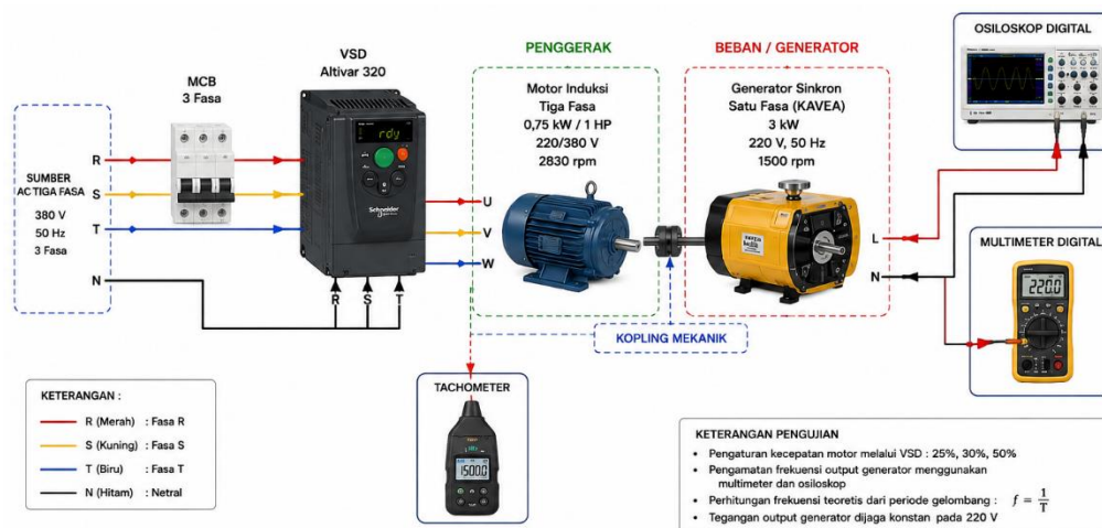
Gambar 2. Rangkaian pengujian motor induksi tiga fasa dan generator satu fasa yang dikendalikan VSD
