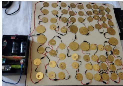
Gambar 2. Rancang Bangun Sistem Pembangkit Piezoelektrik
