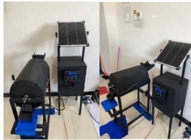
Gambar 8. Hasil Perakitan Akhir Mesin Roasting Kopi
