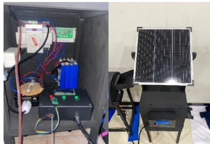
Gambar 7. Hasil Perakitan Sistem Hibrida Listrik–Surya
