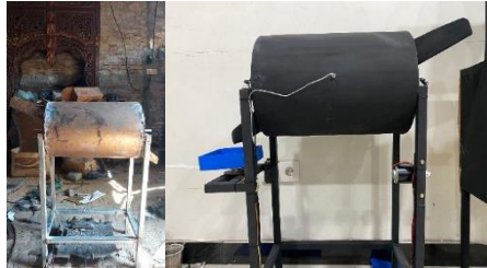
Gambar 5. Hasil Perakitan Rangka Mesin Roasting Kopi
